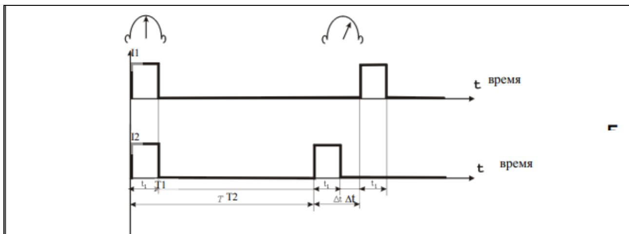
Принципиальная схема компьютерной латерометрии. (А) и дихотического стимула (Б). Стрелками указаны направления потоков данных. T1 – продолжительность электрического импульса; T2 – межстимульный интервал; Dt – шаг нарастания междуенной задержки; I1 – интенсивность сигнала в канале для левого уха; I2 – интенсивность сигнала в канале для правого уха.
