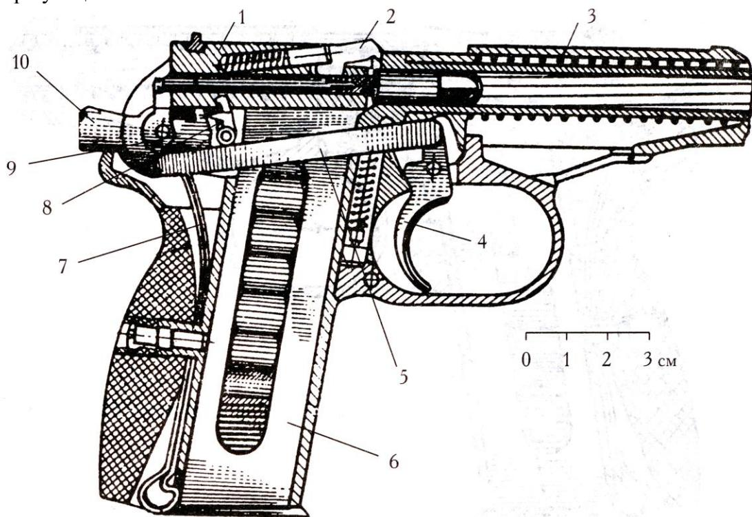
Разрез пистолета ПМ. Положение частей перед выстрелом: 1 — затвор-коужух, 2 — выбрасыватель, 3 — возвратная пружина, 4 — спусковой крючок, 5 — спусковая тяга, 6 — магазин, 7 — боевая пружина, 8 — шептало с пружиной, 9 — рычаг взвода, 10 — курок
