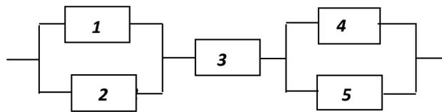
Интенсивность отказов элементов постоянна и имеют следующие значения
