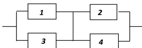
Интенсивность отказов постоянна и равна  $1,35 \cdot 10^{-3} \text{ час.}^{-1}$ . Требуется определить наработку до первого отказа системы.
